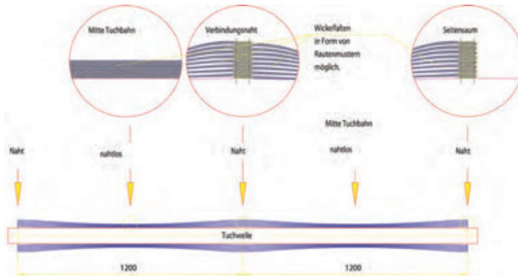
**Bild 9.1.11 Unterschiedlicher Wickeldurchmesser im Naht- und Saumbereich**
