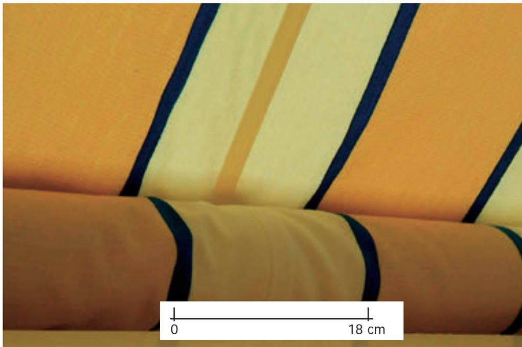
**Bild 9.1.12 Zulässige Stauch- und Wickelfalten auf der Tuchwelle**
