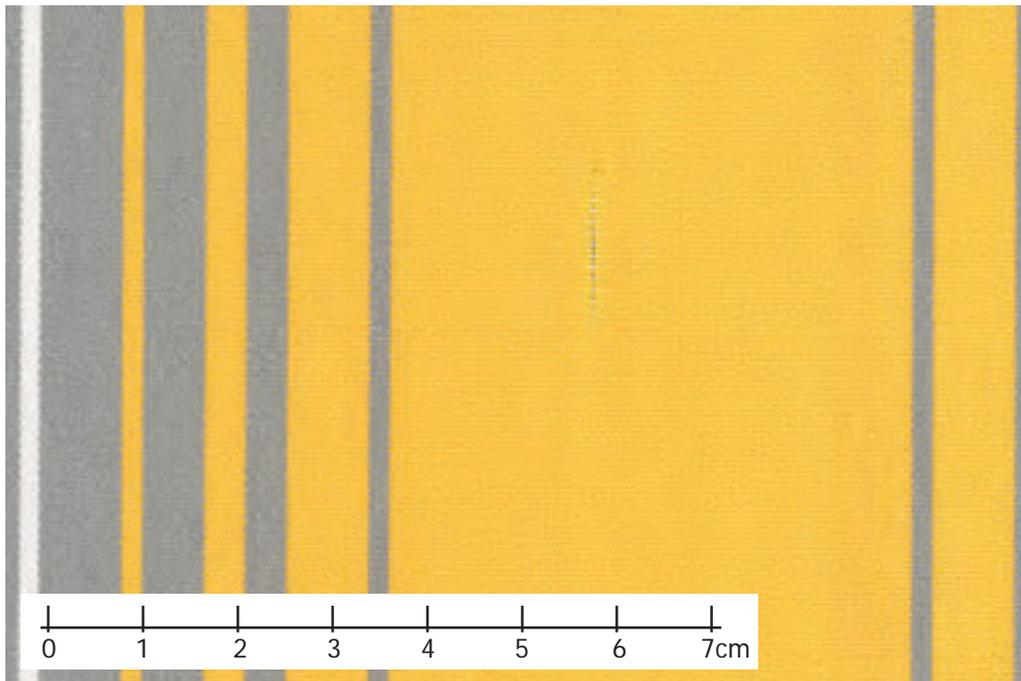
**Bild 9.1.1 Zulässiger kurzer Fadenbruch verbunden mit Lichtdurchlässigkeit**
